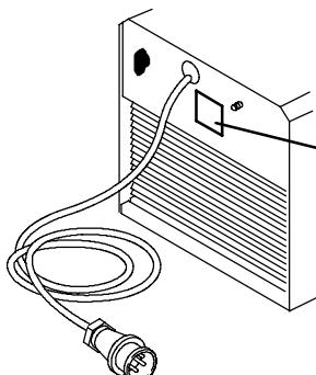
Убедитесь в том, что блок подключен к сети электропитания с требуемым напряжением и защищен предохранителями требуемого номинала. Необходимо обеспечить защитное заземление в соответствии с действующими нормами.
